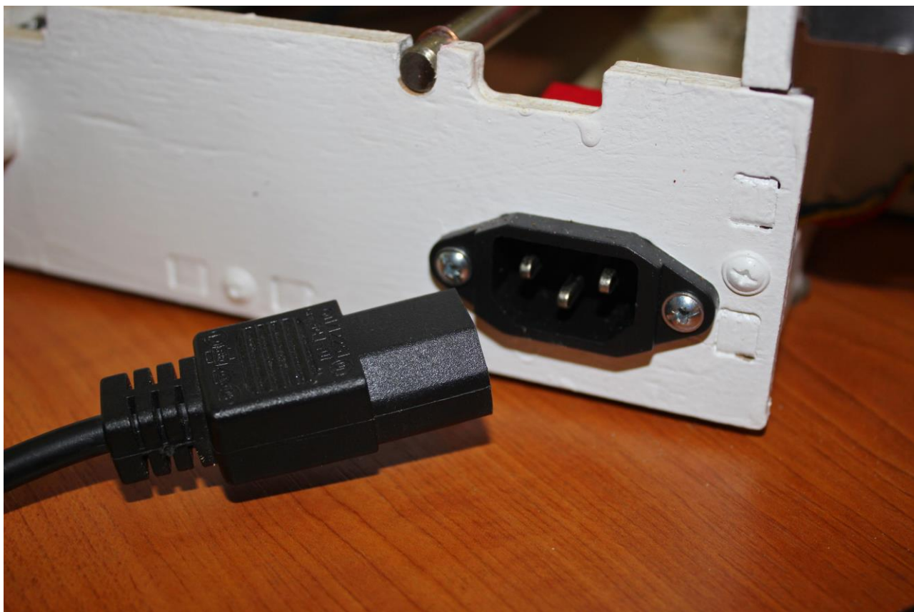
Рисунок 3. Подключение сетевого шнура к 3 D принтеру.
